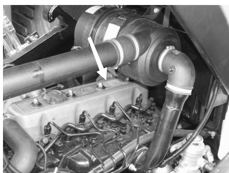
Rysunek 3-2 Położenie tabliczki silnika (na pokrywie głowicy silnika).
