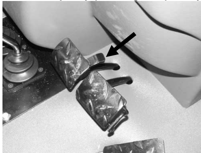
Rysunek 4-18 Zapadka blokująca pedały hamulca roboczego.
