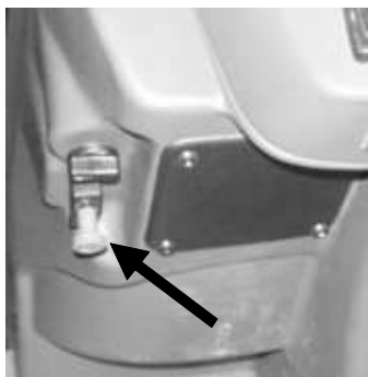
Rysunek 5-9. Cięgło zatrzymania silnika „STOP”
